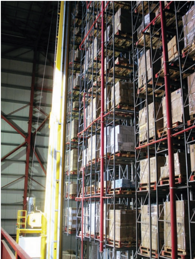
המחסן האוטומטי. האחסון הוא בעומק כפול (Double Deep), המאפשר נצילות אחסון גבוהה
