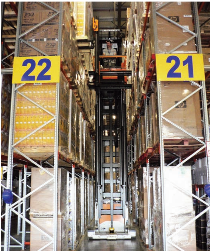
מפעיל מלגזת MX-X מטפל במטען בגובה התמונה באדיבות קבוצת טבת שירותים לוגיסטיים
