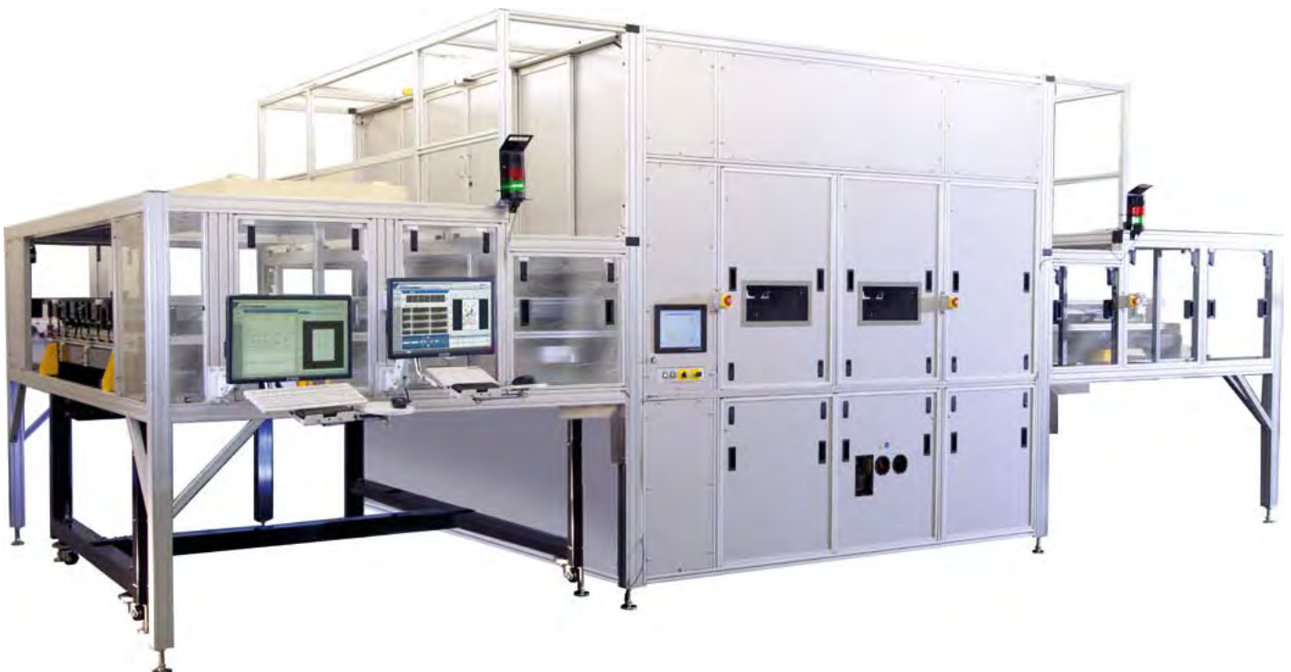
מכונת Quantum בתצורה סופית, כולל מתקני טעינה ופריקה של לוחות זכוכית לצגים שטוחים
