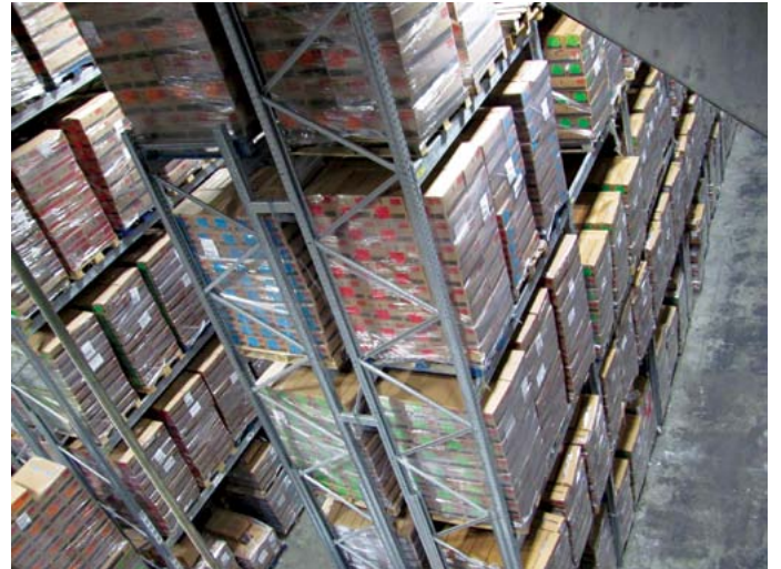
מערכת קונבנציונלית לאחסון משטחים במחסן הקפוא
