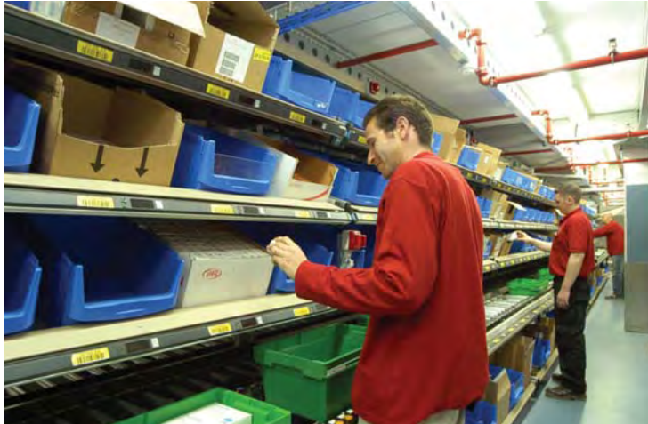
ליקוט על-פי אזור באמצעות מערכת מונחית אור. התמונה באדיבות נובולוג
