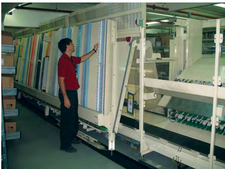
עובד טוען פריטים במכונת ליקוט אוטומטית (A-Frame). התמונה באדיבות נובולוג
