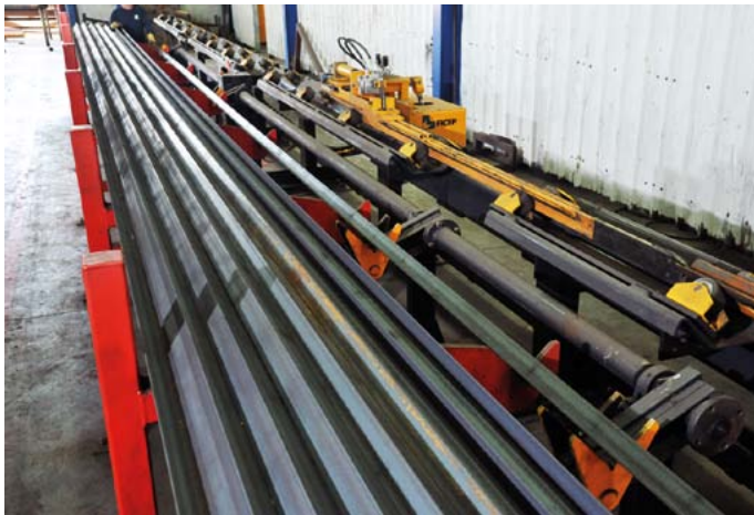
רובוט להזנת מכונת CNC (בתהליך ייצור חלקי מגדל)
