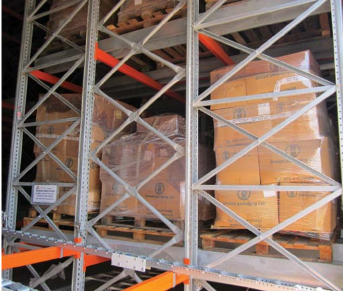
מערכת אחסון בעומק שלושה משטחים (Triple Deep)
