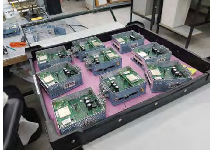
הרכבת המוצר בתוך הזיוד האלקטרוני (הקופסה)
