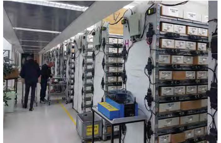
ליקוט רכיבים באמצעות מערכת ייחודית לליקוט על-פי אור
